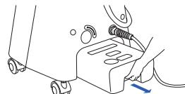
⑥スタートボタンを押して、給水タンク内の水が減っていくのを確認してください。給水中に【E6】が表示された場合には、純水器カートリッジを反時計方向に回して本体から外して水に浸った状態で上下に揺らし再度空気抜きを実行してください。
