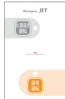
※ **通常運転** ボタンを押しても LED が点灯しない場合にはリモコンコードの差し込みが不十分か断線の可能性がありますので点検をお願いいたします。
